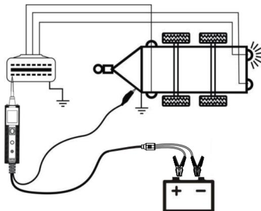
**激活车上部件** 当设备处于直流电压模式时,将探针接触至部件正极,绿色LED指示灯将会亮起,说明此线路是连续性的接地。在看着LED指示灯的同时,迅速向前按压并释放电源开关,如果绿色LED灯熄灭,红色LED灯亮起,表明需要更进一步的激活方式。(如图)如果绿色LED灯熄灭的瞬间,断路器跳闸,说明本产品过载,此种现象可能由如下原因导致:
